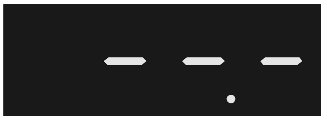
Рис. 3. Индикация ошибки датчика температуры.
